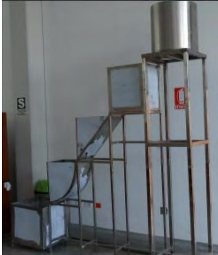
**Figura 3.49. Sistema de tanques ensamblado en el estructura**
