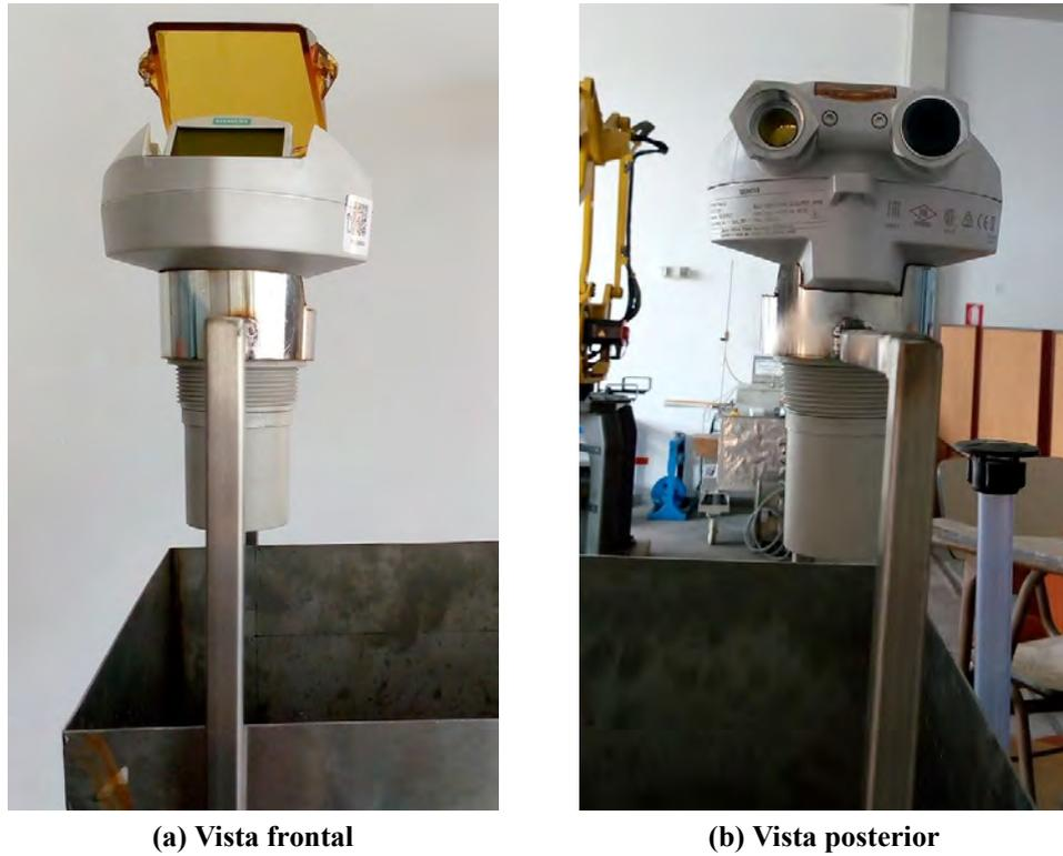
**Figura 3.70. Montaje del sensor de nivel**
