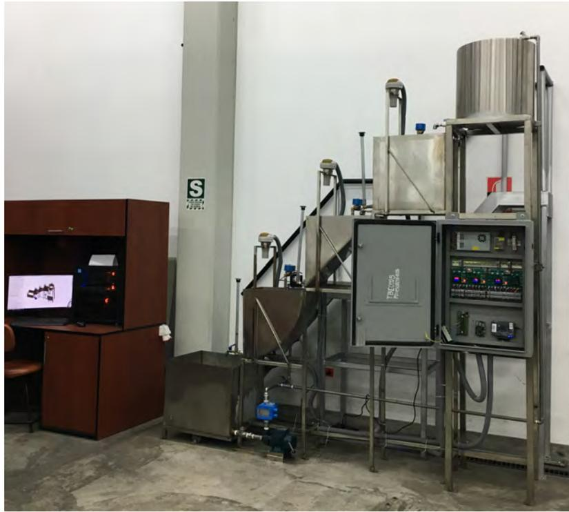
**Figura 3.113. Módulo de control de nivel terminado**
