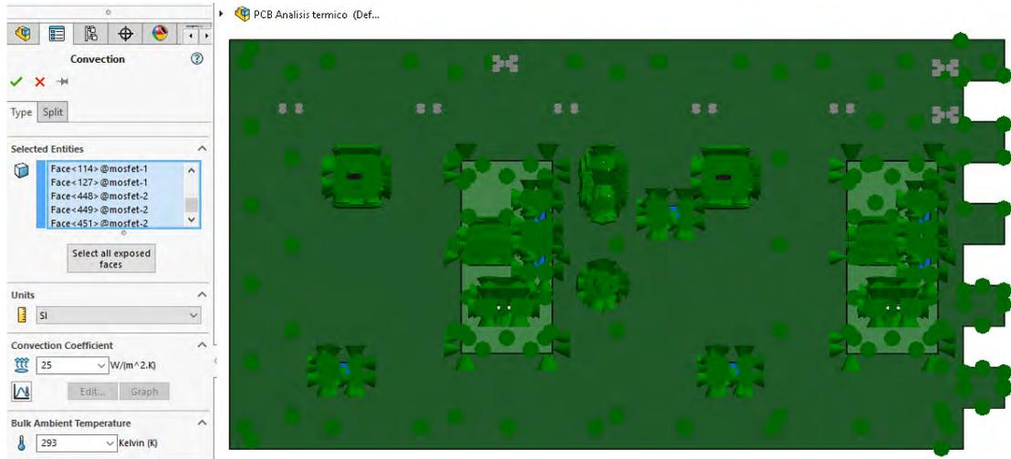
**Figura 3.84. Configuración del coeficiente de convección:  $25\text{W}/\text{m}^2.\text{K}$**
