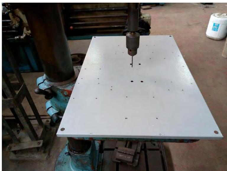
**Figura 3.98. Taladrado del tablero con brocas de 4mm**
