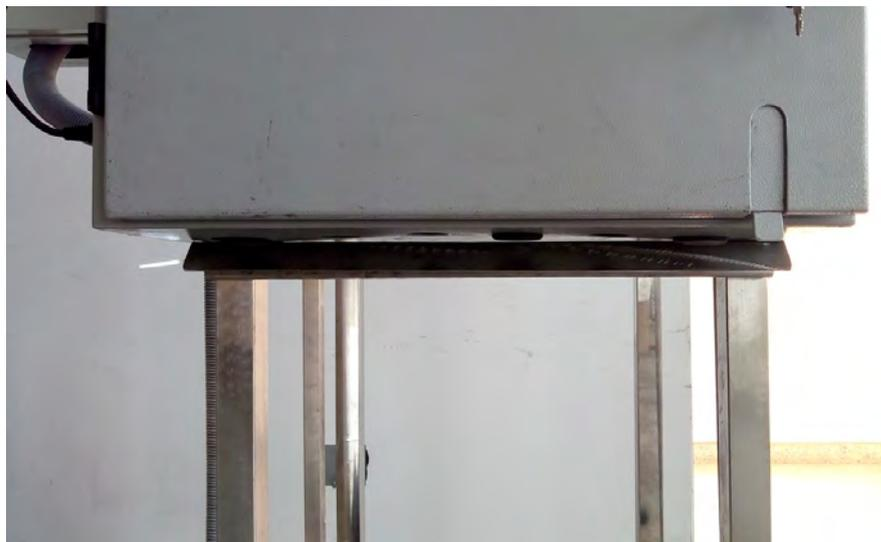
**Figura 3.67. Barra transversal de soporte de la caja de poder general**
