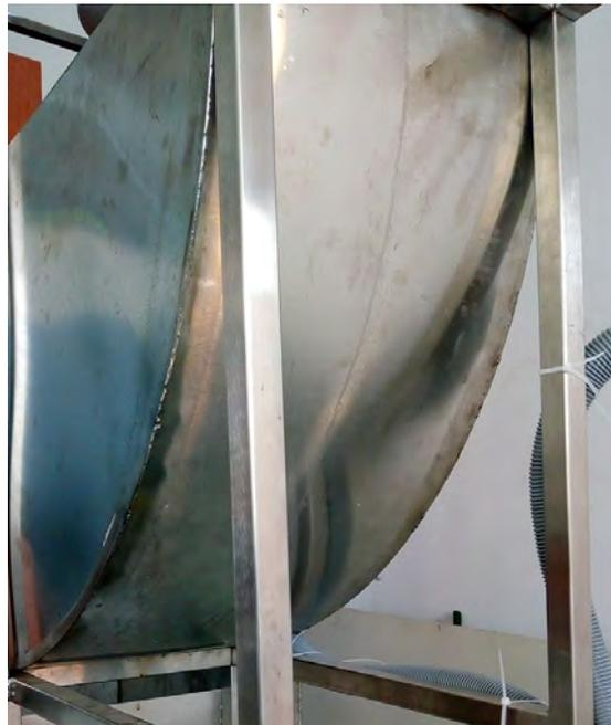
**Figura 3.53. Tanque elíptico soldado en la estructura**
