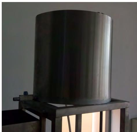
**Figura 3.50. Reservorio cilíndrico soldado en la estructura**
