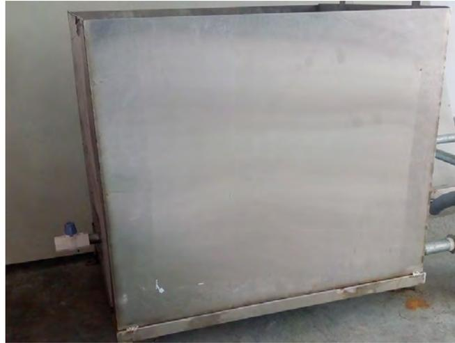
**Figura 3.41. Reservorio rectangular de latón**
