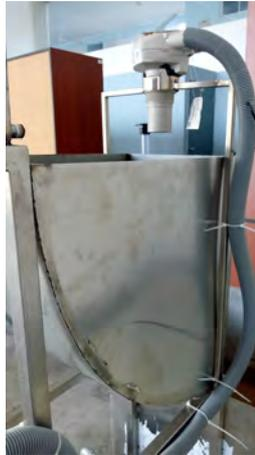
**Figura 3.104. Cableado del sensor del tanque con tubo corrugado**
