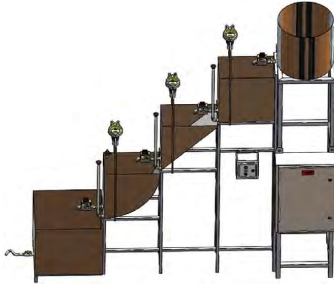
**Figura 3.33. Ensamble de las servoválvulas en los tanques de nivel**
