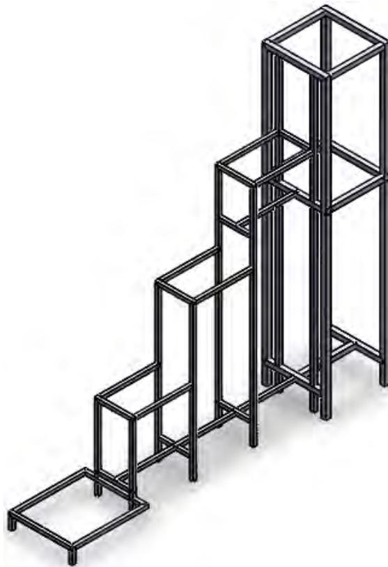
**Figura 3.7. Diseño de la estructura soporte**
