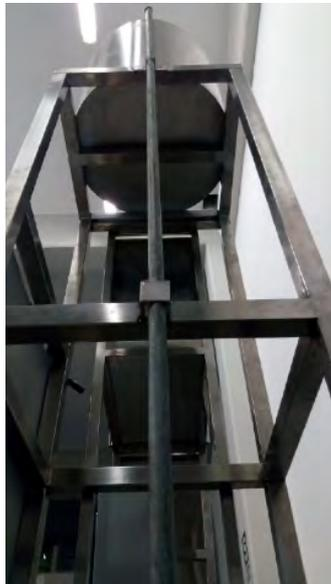
**Figura 3.64. Abrazadera de la tubería longitudinal**
