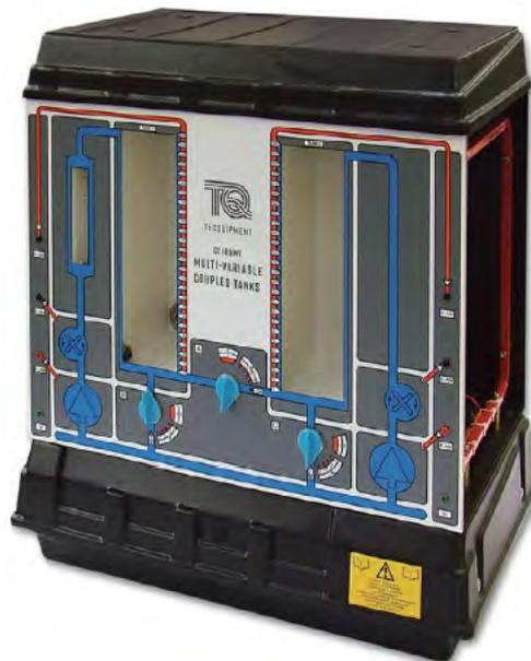
**Figura 1.3. Aparato de tanques acoplados- CE105**
