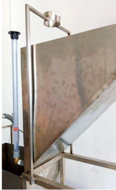
**Figura 3.69. Soporte del sensor de nivel soldado**
