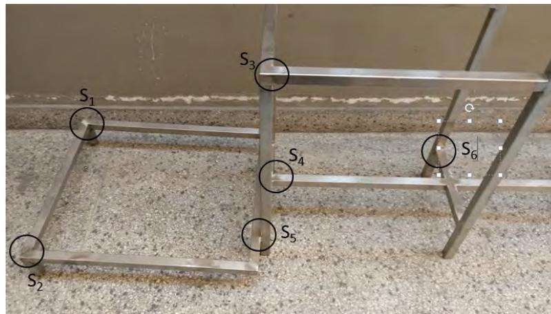
**Figura 3.46. Soldadura en los vértices de unión en las barras del soporte**
