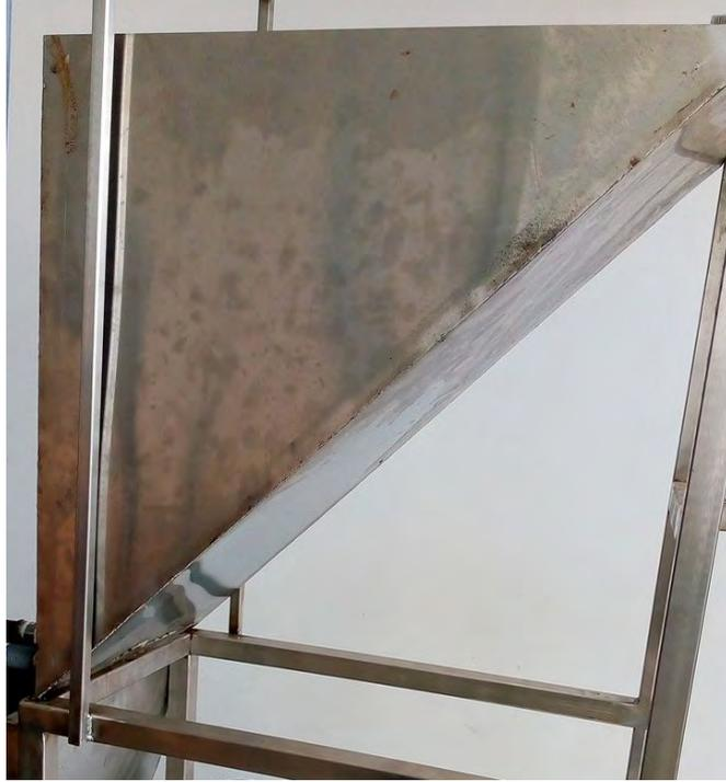
**Figura 3.52. Tanque triangular soldado en la estructura**
