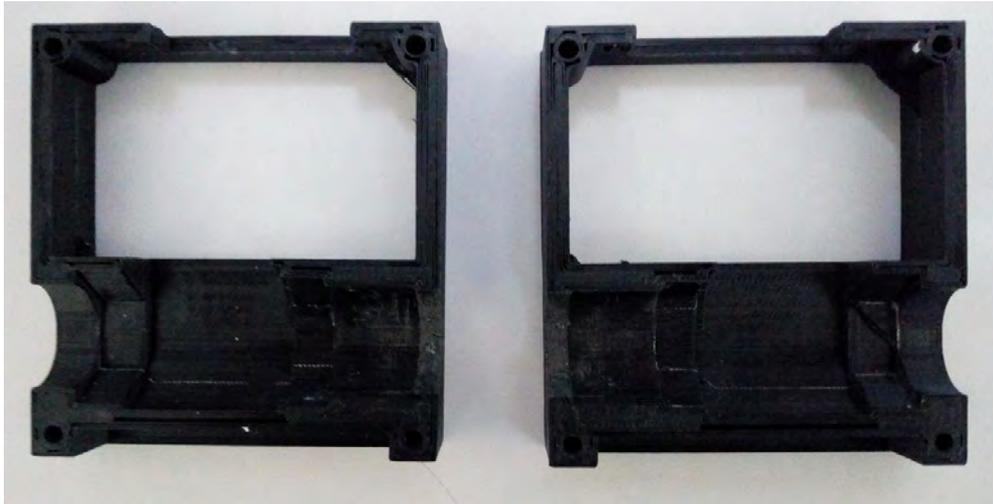
**Figura 3.59. Piezas que componen la caja de la servoválvula**
